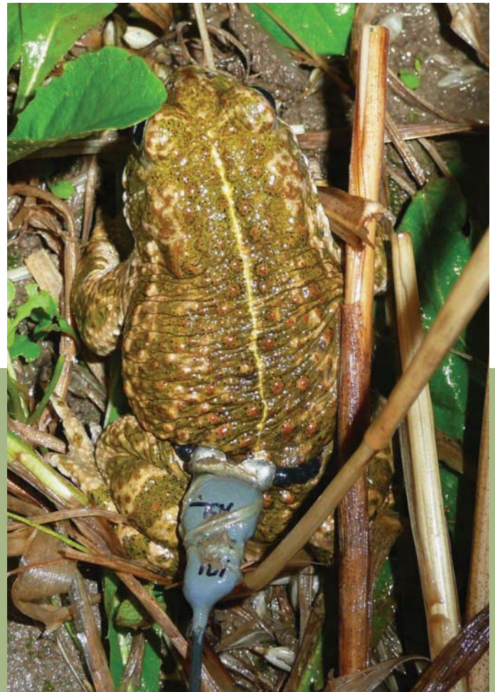
Fig. 1: L'émetteur externe avec antenne flexible est fixé à l'aide d'une sangle ventrale (photo: E. Schweizer).
