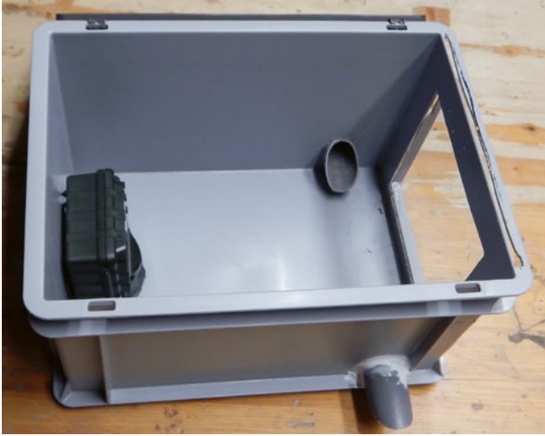
Abbildung 1: Prototyp der MiniMammalCamBox. Innenansicht der ersten Variante der MiniMammalCamBox aus einer Rako-Box und einer speziell auf Kleinsäuger ausgerichteten Fotofalle, mit gegenüberliegendem, grossem Fenster aus Glas und seitlichen Eingängen aus PVC-Röhren. Dieser Prototyp wurde im Laufe der letzten Jahre optimiert (z. B. ohne Glas und Anbringung der Fotofalle an der langen Seite der Kiste), siehe Abbildung 3. Foto: Lorenzo Vinciguerra.
