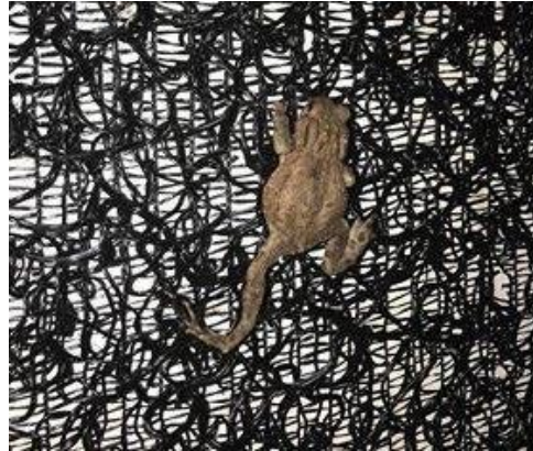
Abb. 4. Amphibienleiter aus Geotextil (SYTEC Terramat).
