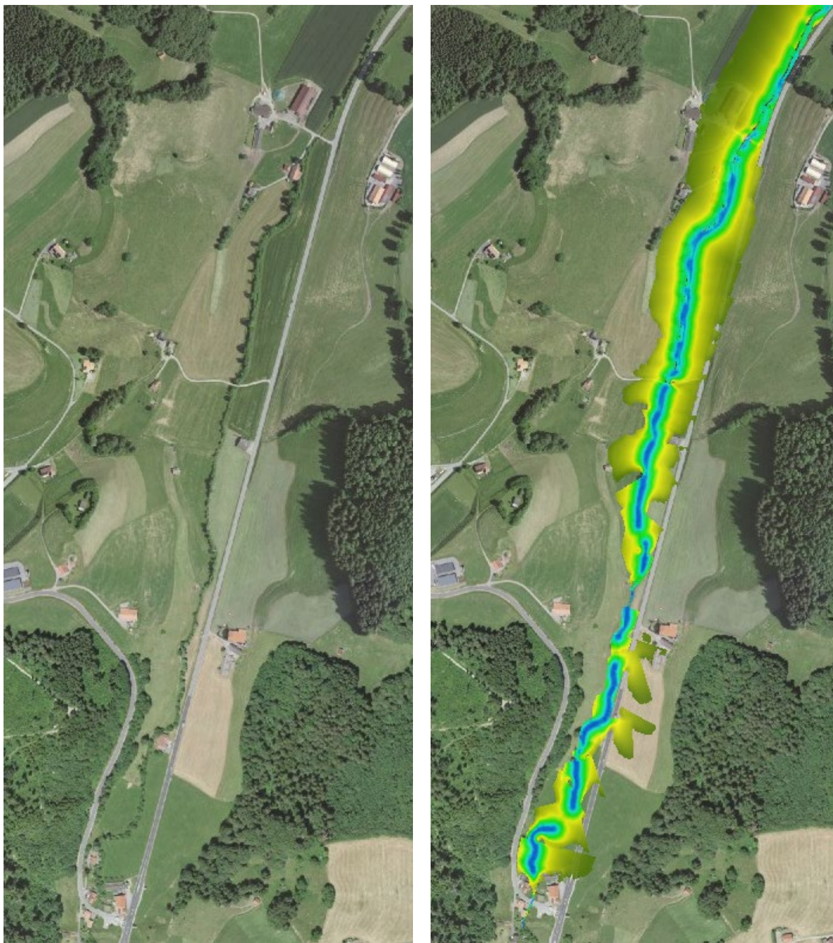
Fig. 3 Ruisseau proche de la route. Si le castor arrive et commence à créer des barrages, la route et les champs adjacents pourraient se retrouver sous l'eau (modèle de hauteur du barrage : 0,5 m). La probabilité que de l'eau se retrouve à un endroit va de 100% (en bleu) à 0% (vert clair) à travers un gradient de jaunes.
