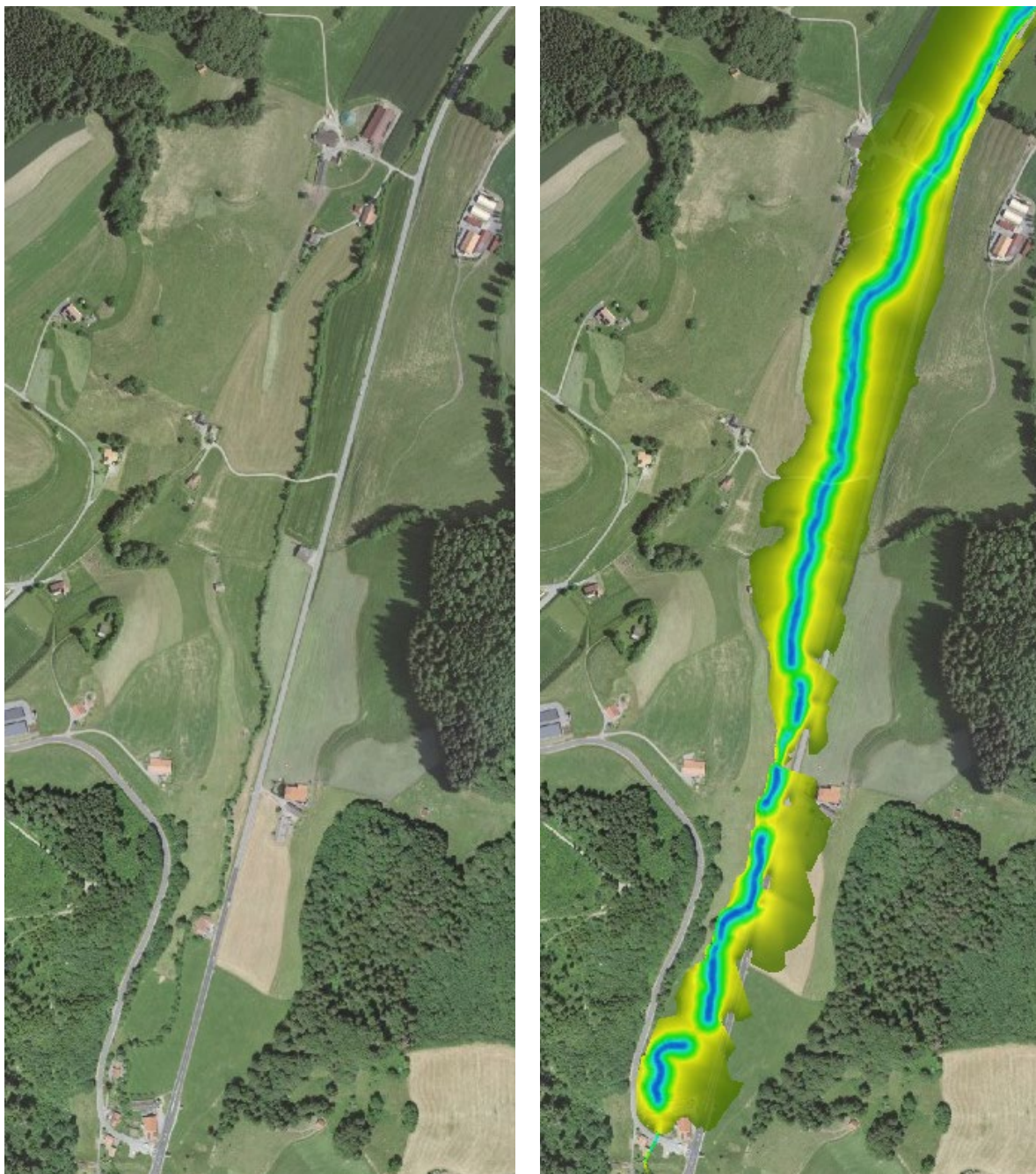
Fig. 4 Ruisseau proche de la route. Si le castor arrive et commence à créer des barrages, la route et les champs adjacents pourraient se retrouver sous l'eau (modèle de hauteur du barrage : 1,5 m). La probabilité que de l'eau se retrouve à un endroit va de 100% (en bleu) à 0% (vert clair) à travers un gradient de jaunes.
