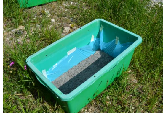
Abbildung 2: Mit Beton ausgegossene Plastikwanne
