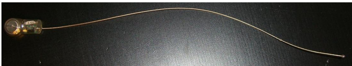
Figure 1 : Emetteur modèle R1680 implanté dans les sujets suivis
