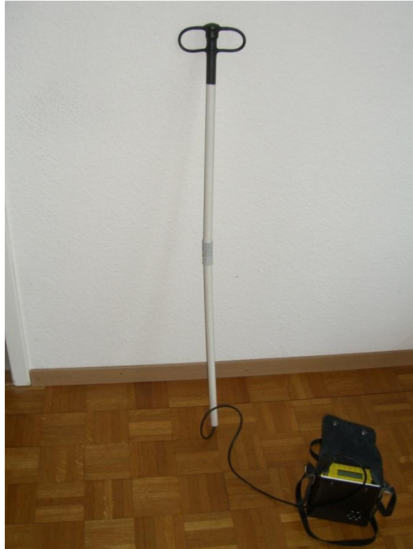
Figure 4 : Antenne directrice de type Loop permettant l'acquisition du signal à courte distance
