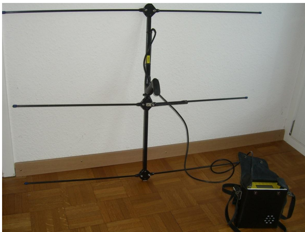
Figure 3 : Antenne directrice de type Yagi permettant l'acquisition du signal à longue distance
