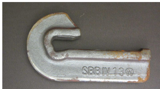
Abbildung 6: Wanderklemme zur Befestigung der Amphibienableitbleiche
