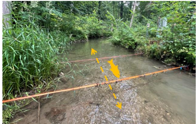
Abbildung 3-2: Doppelantenne unterhalb des Biberdammes am Schwarzbach. Zwei Antennen, die nacheinander im Bachbett stehen, erlauben unter anderem die Bestimmung der Schwimmrichtung.
